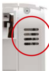
Czujnik temperatury i wilgotności wewnętrznej
